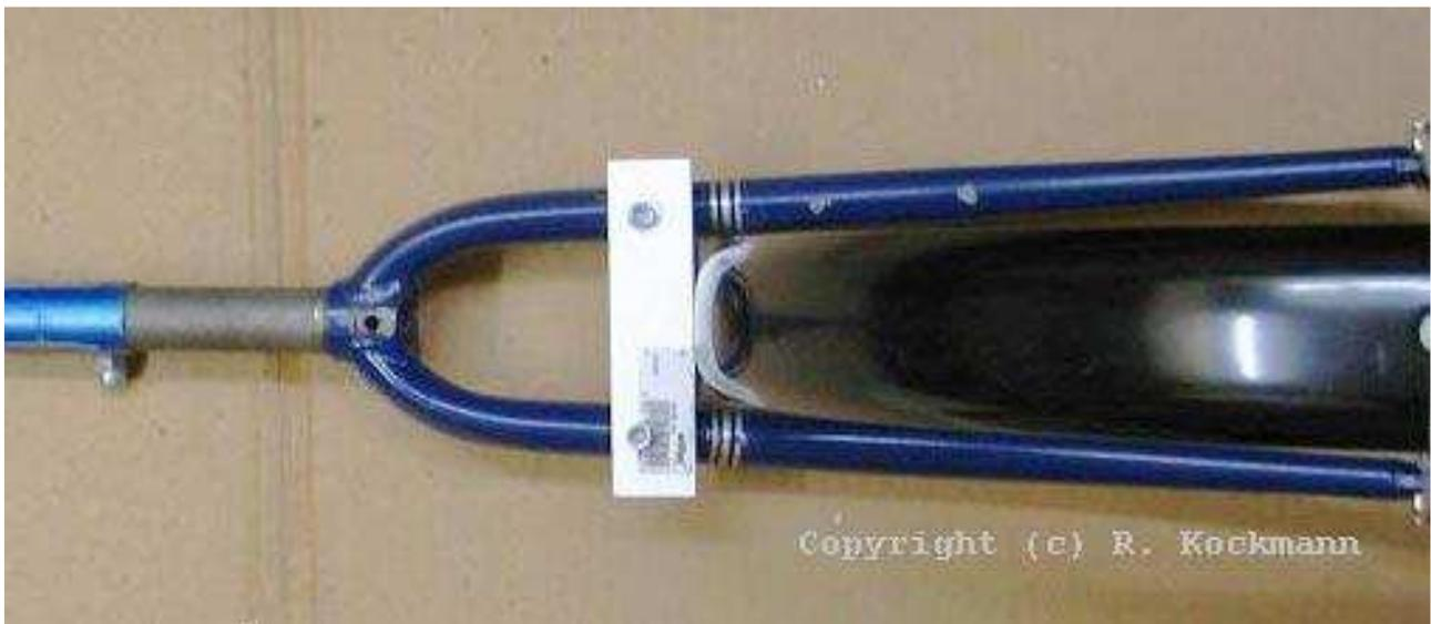
*Radgabel für das 20"-Rad mit befestigtem Schutzblech (Ansicht von oben).*
