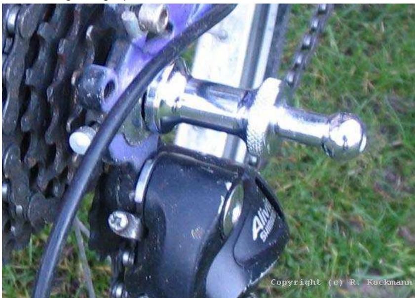
*Ausgewechselte Schnellspann-Achse für die Aufnahme der Anhänger-Kupplung.*
