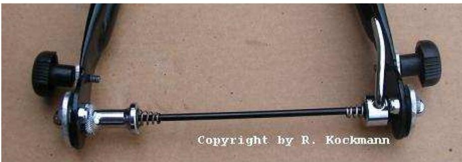
*Die Schnellspannachse mit eingehängter Kupplung und Sicherung.*
