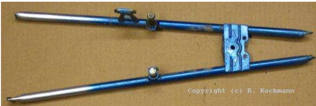
*Die Hinterrad-Streben des Fahrrades dienen später zur Verstrebung der Anhänger-Kupplung*
