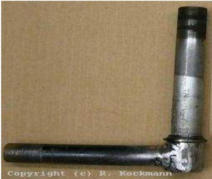
Die Teile eines Vorderrad-Gabel-Schaftes neu verschweißt zum vorderen Teil des Rahmens.
