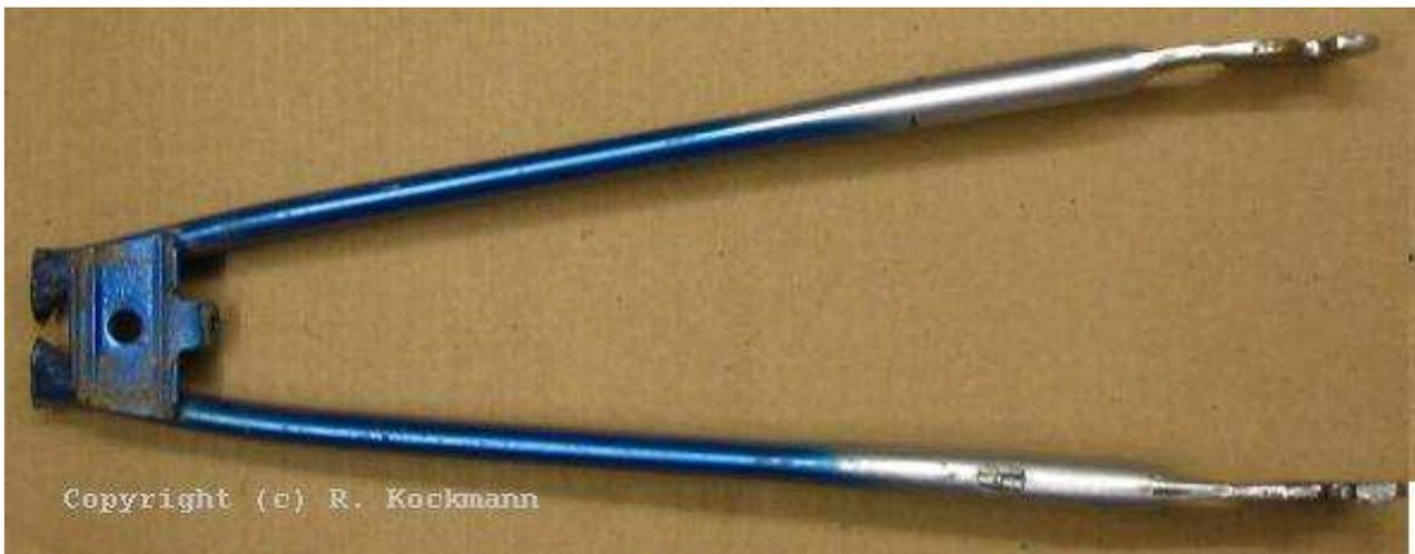
*Die Hinterrohre (Hinterradgabel) des Fahrrades dient als Hauptteil der Anhängerkupplung.*
