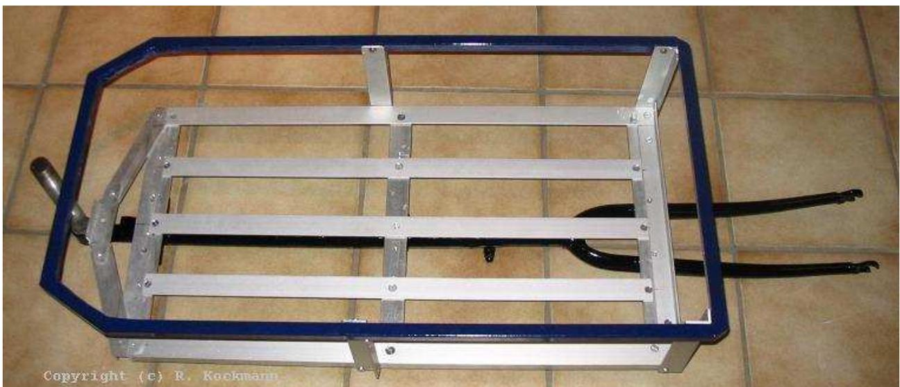
Das montierte Ladegestell mit dem Rahmen aus Stahlrohr (blau).
