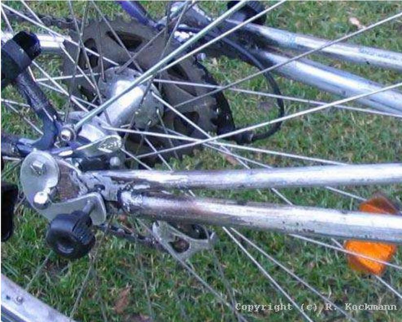
*Die Sicherung nach dem Einhängen der Kupplung in Aktion.*
