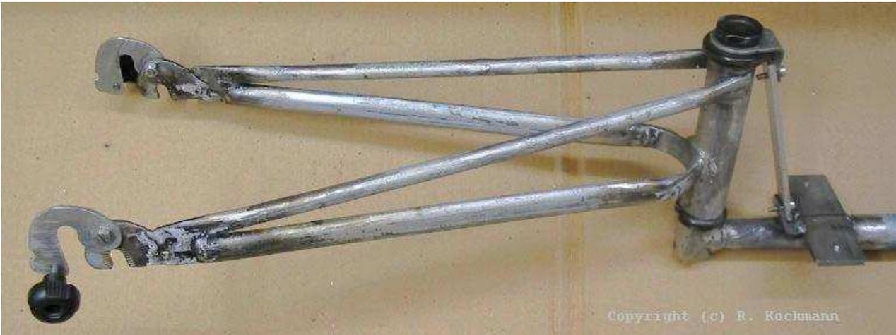
*Die bewegliche Kupplung mit der umklappbaren Sicherung an jeder Seite.*
