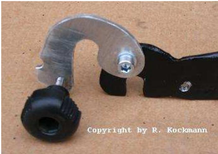
*Die Sicherung für die eingehängte Kupplung*
