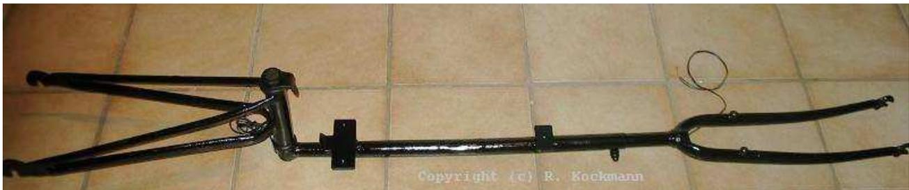
Der lackierte Rahmen mit Kupplung und Gabel. Das Lichtkabel wird durch das Rahmenrohr geführt.
