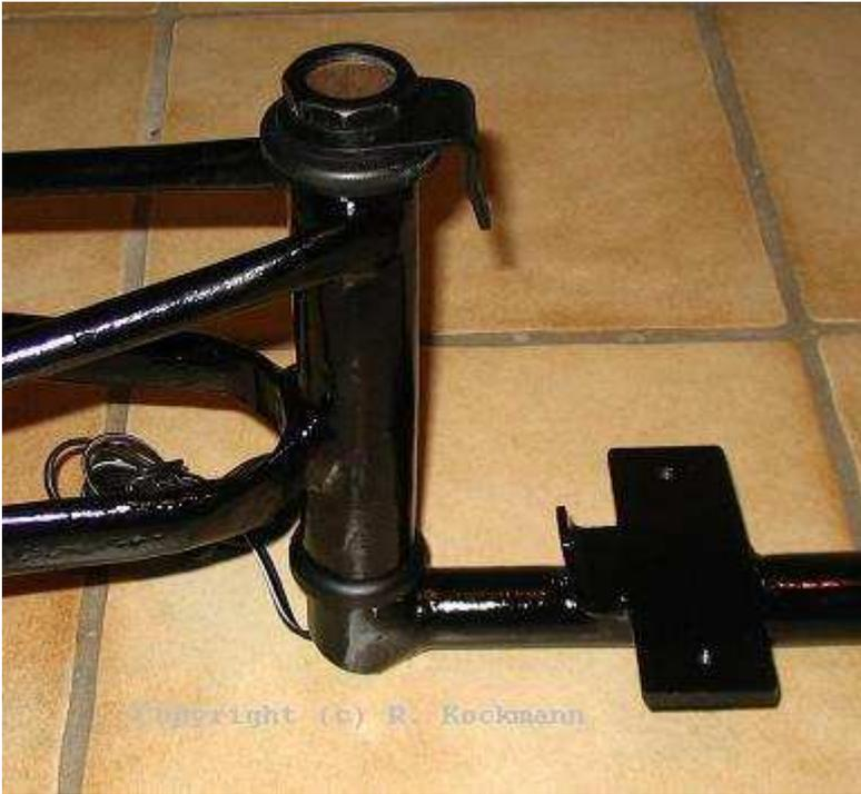
*Der Steuerkopf und die vordere Befestigung der Ladefläche und der Verstrebung (für den Steuerkopf)*
