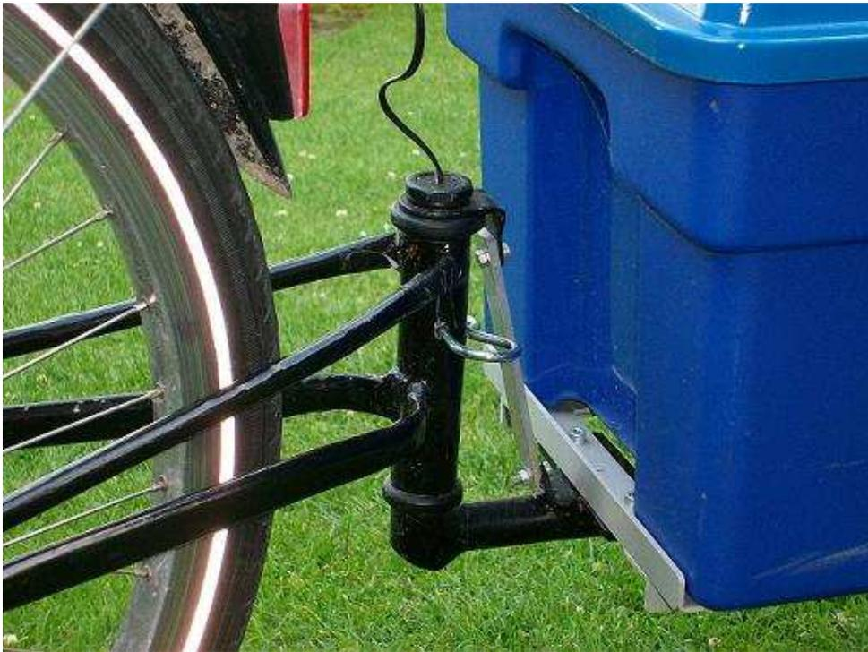
*Splint-Sicherung am Steuerkopf der Kupplung des Anhängers*
